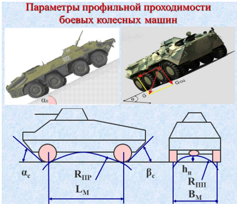
Рис. 1. Параметры профильной проходимости боевых колёсных машин
