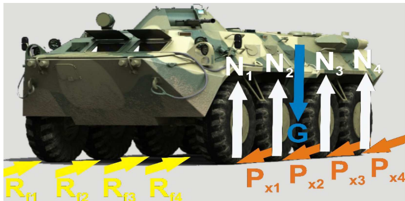
Рис. 2. Распределение нормальной реакции грунта от действия силы тяжести, тяговой силы и сил сопротивления качению БТР-80
