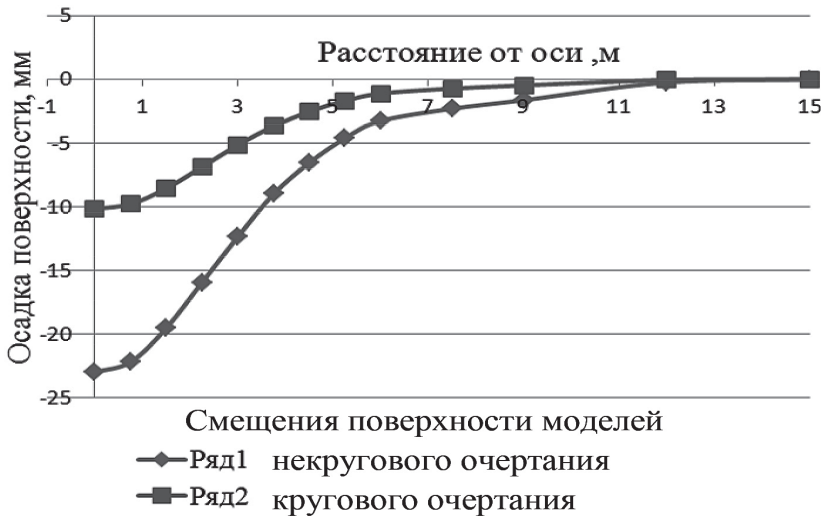
Рис. 4. Мульда смещений поверхности моделей при величине заходки 0,7 м и давлении 650 кПа
