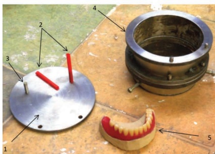
Рис. 10. Снятые и накрученные на винты пластмассовые трубки с залитым базисным расплавляющимся воском.
