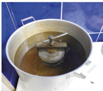
Рис. 26. Кювета подготовлена для полимеризации на «водяной бане».
